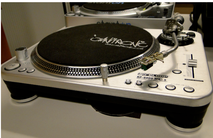
Bewährt sich in allen Fällen, in denen eine optische Abtastung nicht möglich ist: der Reeloc RP-6000 ML 5 S mit einem Stanton Tonabnehmer. Ein solches Laufwerk ist auch für sehr schwere Schellackplatten geeignet. Die Geschwindigkeit kann reguliert werden.
