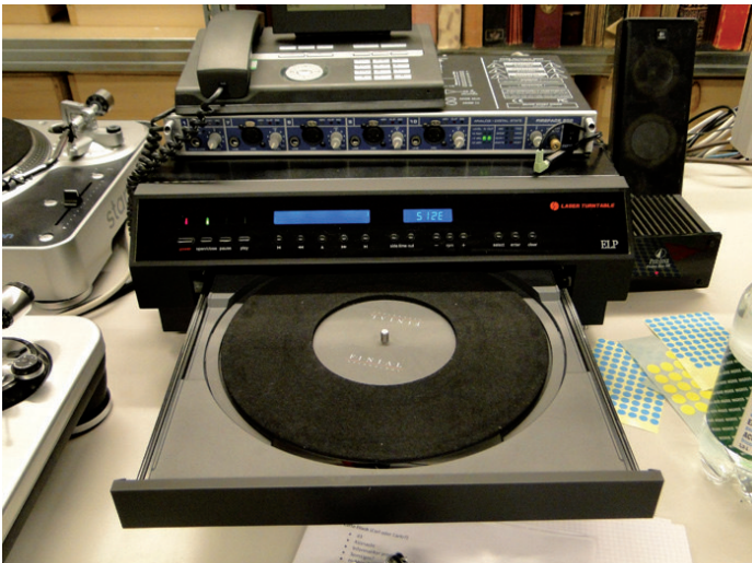
Eine optische Abtastung ist optimal für eine Digitalisierung. Hier der wertvolle und kaum ersetzbare «Laser Turntable» von ELP.
